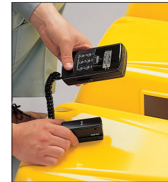
塗装後の外観検査
